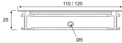
**Kabeldurchführung aus Aluminium, mit geradem Klappdeckel, schwarzer Bürstendichtung und **Soft close Mechanismus****
